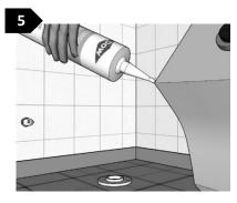
Coloque el sanitario en posición invertida, y previamente añada un hilo de pega sobre todo el perímetro de este. Por recomendación use sikaflex o sementó blanco para obtener un mayor sellamiento.
