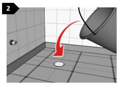
Realice una prueba de flujo para comprobar que la tubería no se encuentra obstruida. Para esto descargue cierta cantidad de agua dentro de la tubería.
