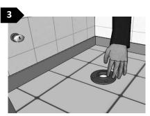
Instalación de la brida: Inserte la brida de goma con ayuda de sus manos en la boca del desagüe. No es necesario marcar o hacer perforaciones ya que al momento de sentar el sanitario esta forma un sello entre la sifa del sanitario y la tubería.
